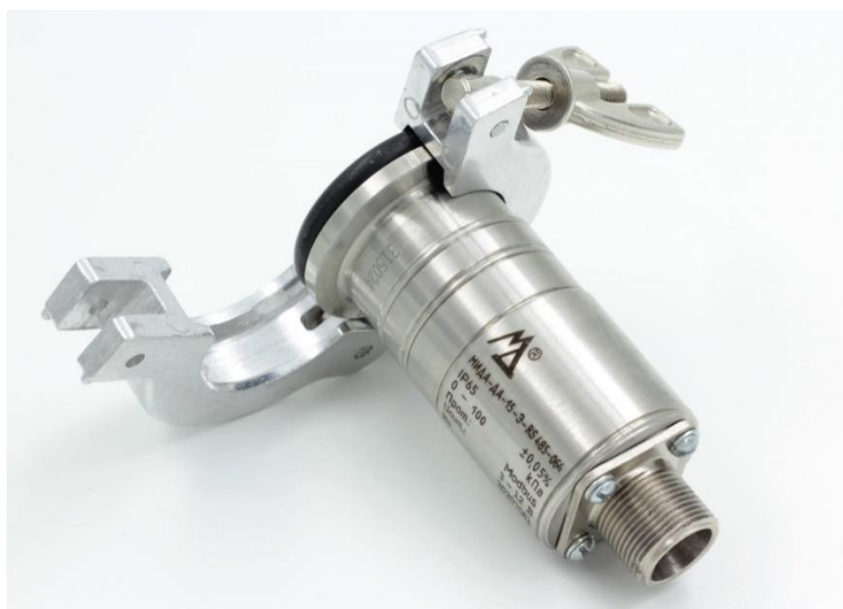
Рисунок 2. Эталонный датчик абсолютного давления МИДА-ДА-15-Э с хомутом для присоединения к вакуумной системе.
