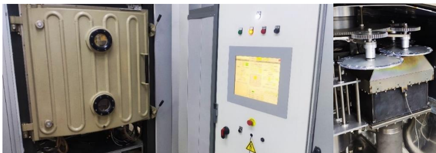
Рисунок 3. Вакуумная камера, шкаф управления и часть внутрикамерной оснастки.
