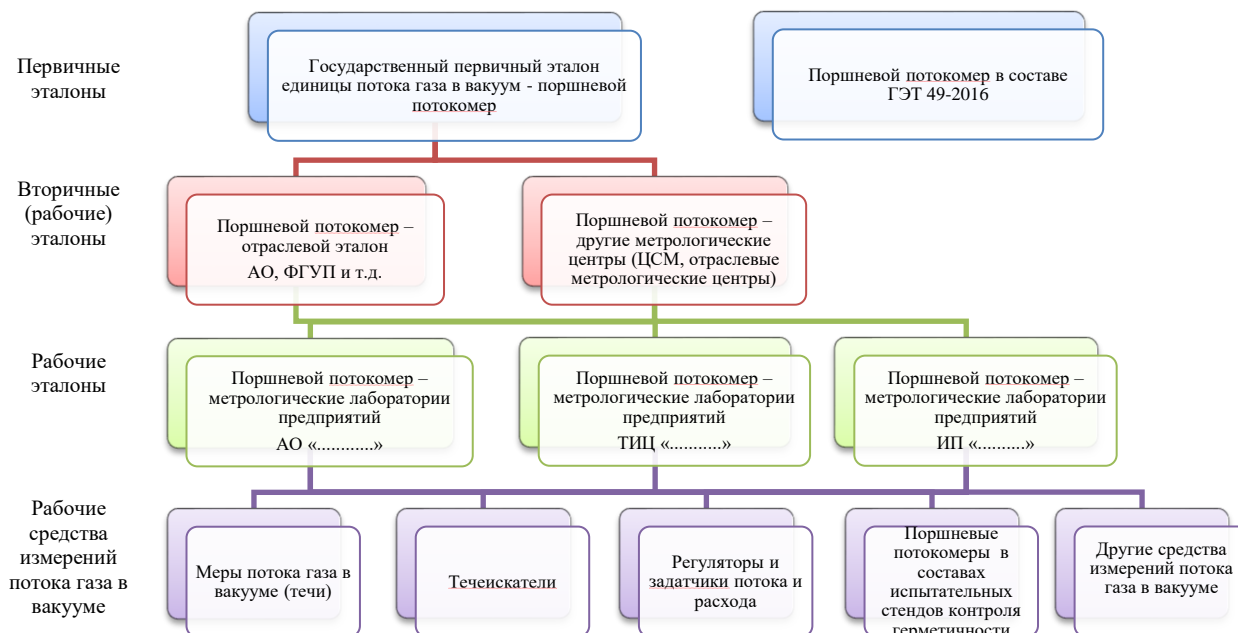
Рисунок 4. Структурно-иерархическая схема системы метрологического обеспечения в области измерений потоков газа в вакууме на базе поршневого потокомера.
