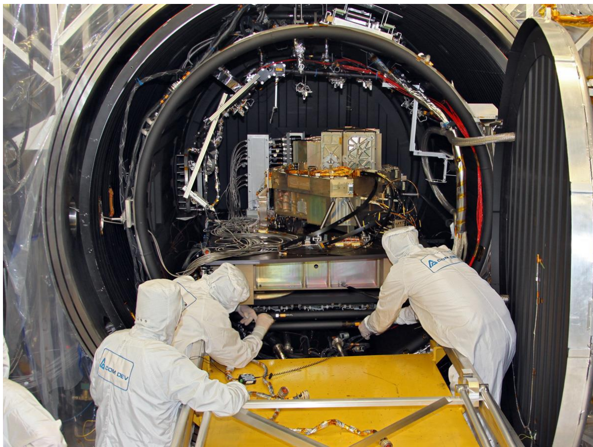
Рисунок 3. Вакуумная установка TV3 [2,3].
